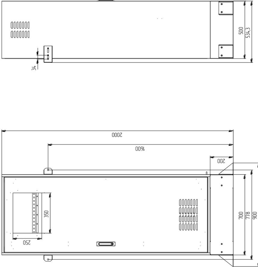
Рисунок 2. ТШВ-1875Н2 Чертеж общего вида.
