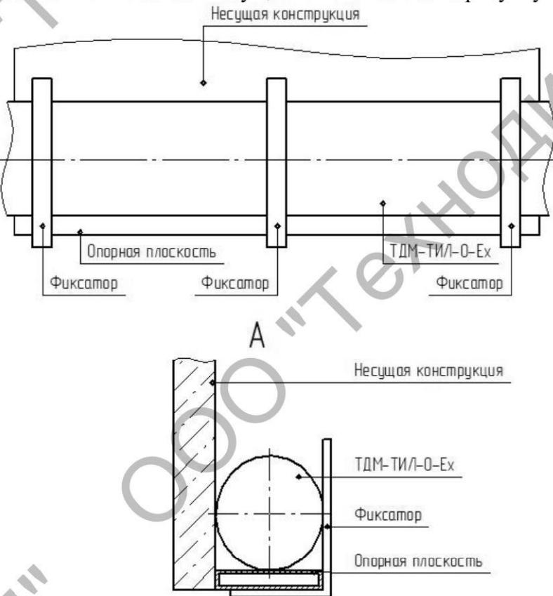
Рисунок 2 - Пример монтажа линии в горизонтальной плоскости.
